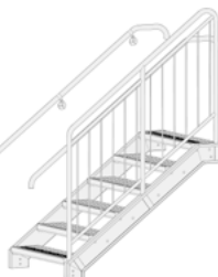
Enkeltløbstrappe uden afstigningsrepos
