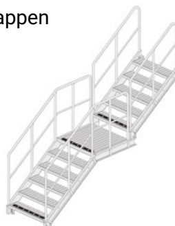
Toløbstrappe med hvileplatform
