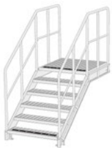
Enkeltløbstrappe med afstigningsrepos
